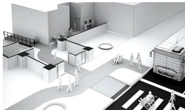
Perspectiva: Representación de una ruta accesible en edificación y conectada con el espacio público adyacente.
